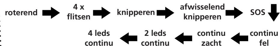
Om de lamp uit te zetten zonder alle standen te moeten doorlopen, houdt u de aan-uitknop 2 seconden ingedrukt. 2 leds zullen 5 maal knipperen en dan uitgaan. Om de lamp weer aan te zetten drukt u 1 maal op de aan-uitknop; de lamp zal zijn laatste stand hernemen.
