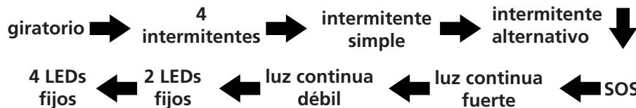
**Para apagar la lámpara sin pasar por los 9 modos,** mantener pulsado el botón de encendido/apagado durante 2 segundos: 2 LEDs parpadean 5 veces y luego se apagan. Para volver a encender la lámpara, pulsar una vez el botón de encendido/apagado: la lámpara se enciende con el último modo activo en el momento de la desconexión.
