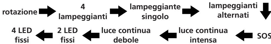
Per spegnere la lampada senza passare attraverso le 9 modalità, tenere premuto il pulsante di accensione/spegnimento per 2 secondi: 2 LED lampeggiano 5 volte e poi si spengono. Per riaccendere la lampada, premere una volta il pulsante di accensione/spegnimento: la lampada si accende con l'ultima modalità attiva al momento dello spegnimento.
