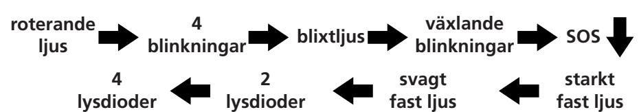
Tryck och håll ner on/off-knappen i 2 sekunder för att stänga av varningsljuset (2 lysdioder kommer att blinika 5 gånger innan det stängs av). Varningsljuset återgår automatiskt till det senast valda lysläget när du sätter på det igen.
